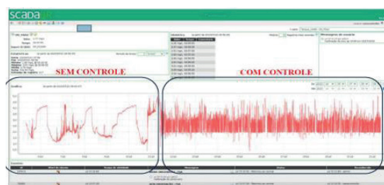
Fig. 1 - Gráfico de resposta do oxigênio dissolvido (OD) antes e depois do controle de aeração no FSA
