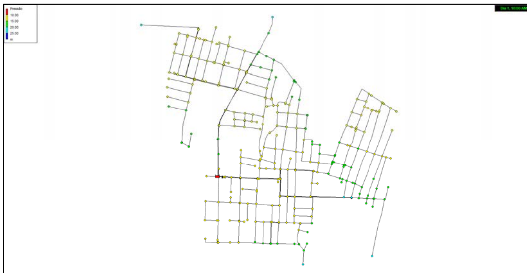
Figura 15: Rede de distribuição modelada no software EPANET proposta para o DMC Itambé
