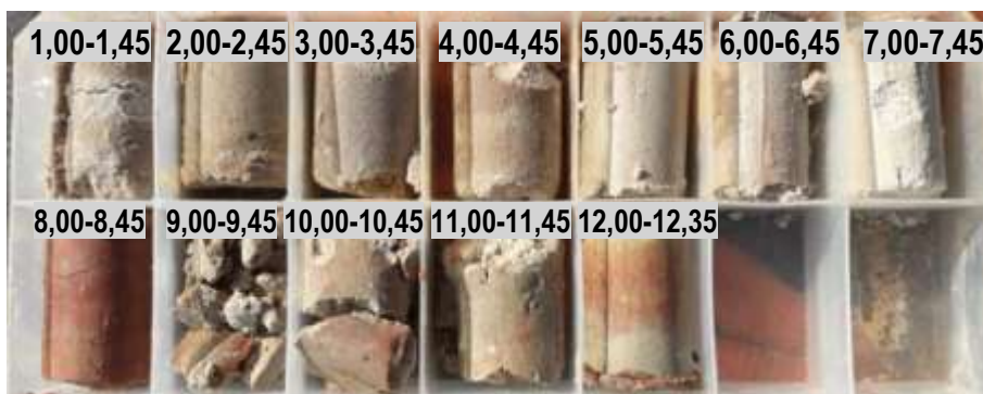
Amostragem do furo SPT-EEE02
