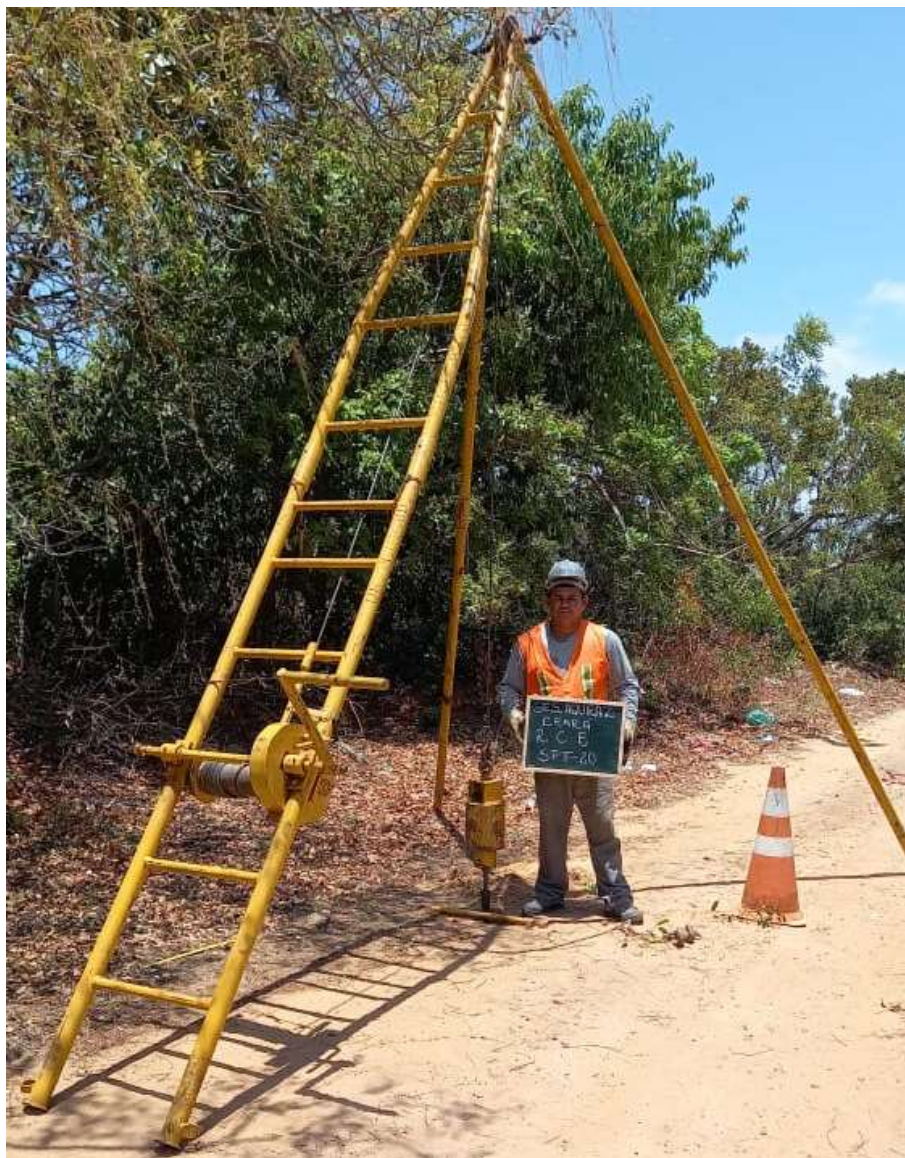
Instalação do furo SPT-20
