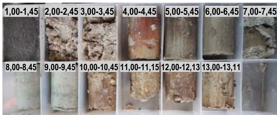
Amostragem do furo SPT-EEE07
