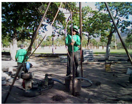
Foto 02- Idem, idem, foto 01, vendo-se o início da operação de lavagem para atingir a cota de amostragem .
