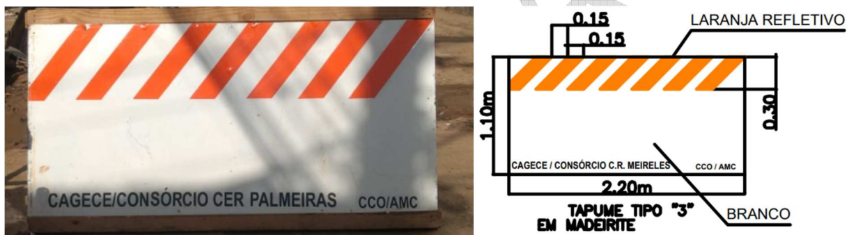
Figura 25 - Tapume para trecho reto
