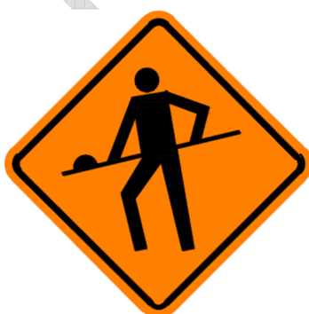
Figura 6 - Sinalização de obras ou serviços na via
