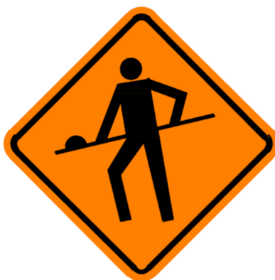
Figura 6 - Sinalização de obras ou serviços na via
