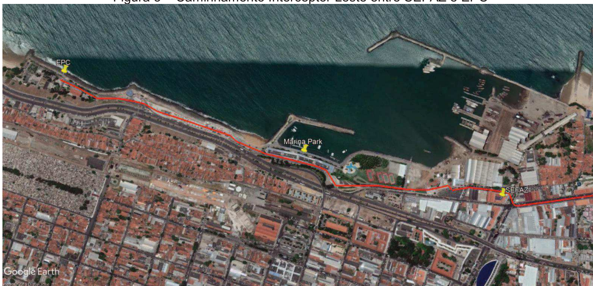
Figura 3 – Caminhamento Interceptor Leste entre SEFAZ e EPC
