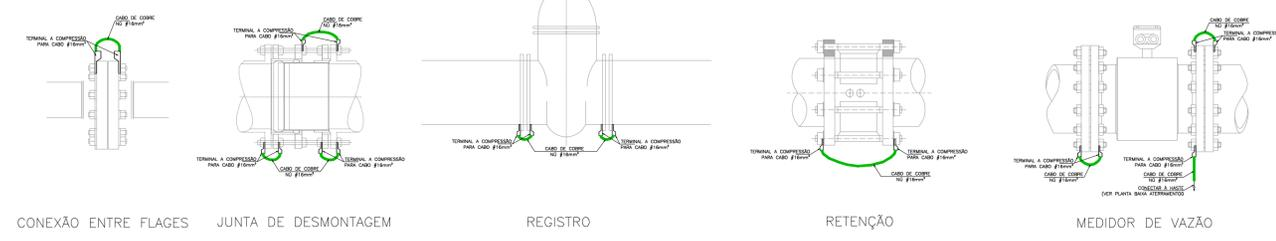
6 - DET. EQUIPOTENCIALIZAÇÃO DO MEDIDOR DE VAZÃO
