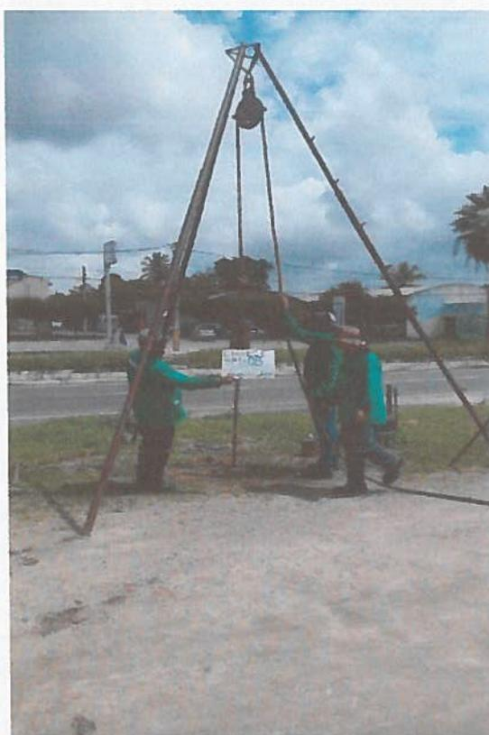
FOTO 16: Detalhe da identificação do furo SP-08.
