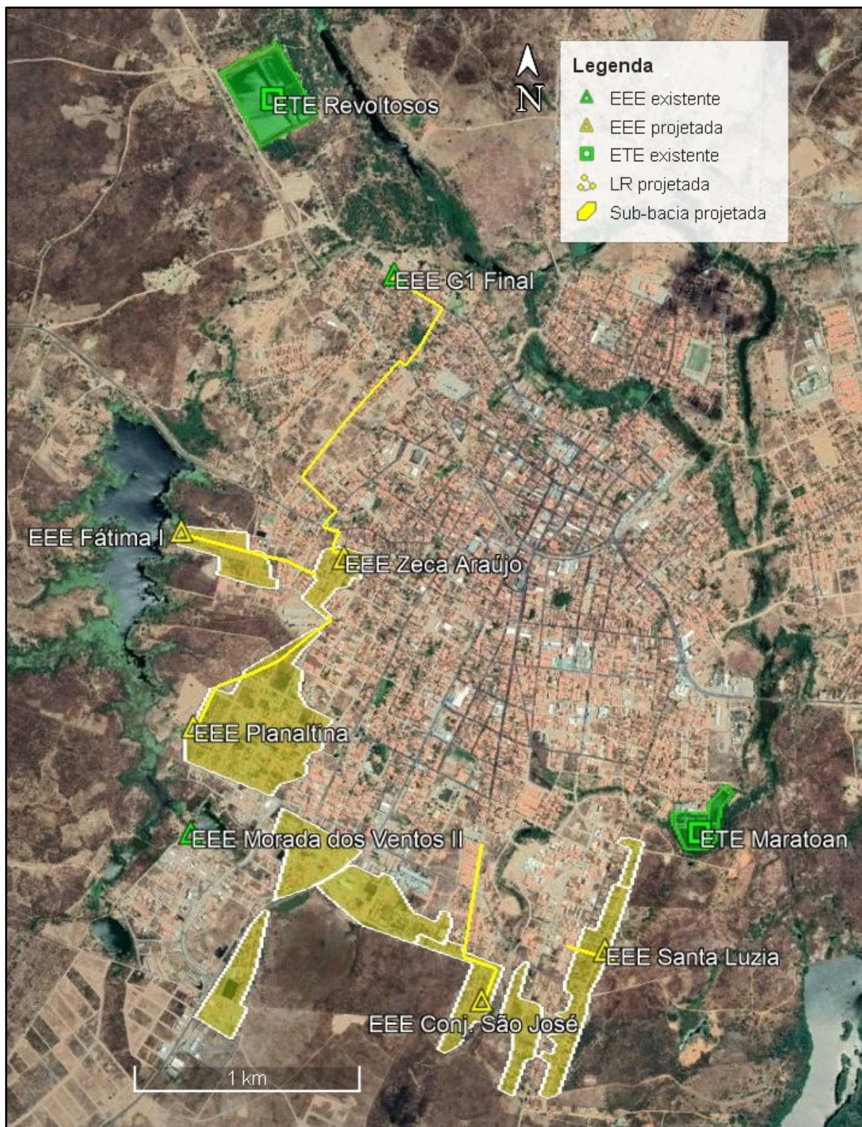
Figura 6.1 – Mapa do sistema de esgotamento sanitário projetado.
