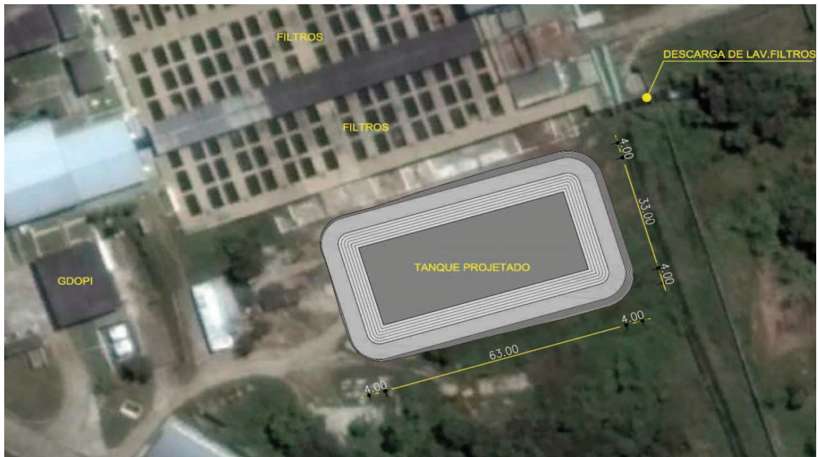
Figura 04 – Alternativa de locação do tanque selecionada
